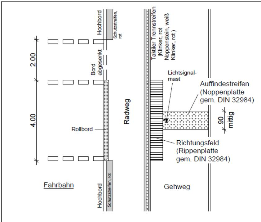
Bild 5: Querung mit Lichtsignalanlage und durchgehender Radwegführung
