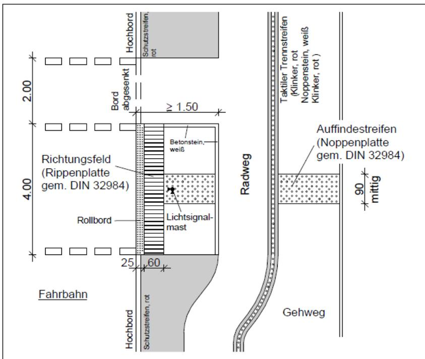
Bild 6: Querung mit Lichtsignalanlage und verschwenkender Radwegführung
