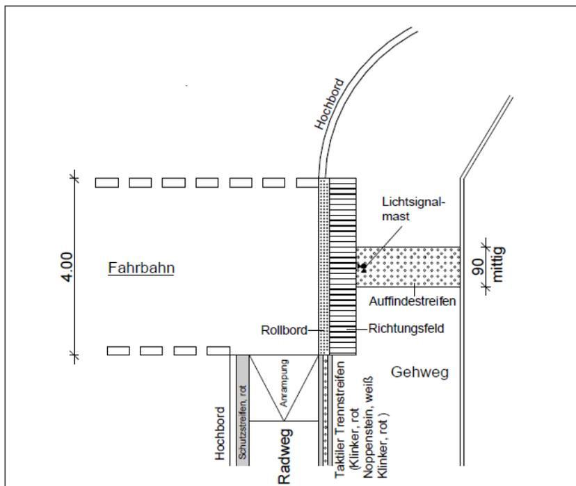
Bild 4: Querung mit Lichtsignalanlage
