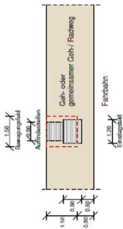
Die Bewegungsfeld (1.50m x 1.50m) an der fahrzeugseitigen Einseitigshalle ist von Einbauten freihalten.
