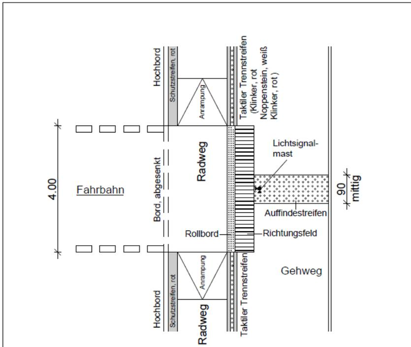
Bild 3: Querung mit Lichtsignalanlage
