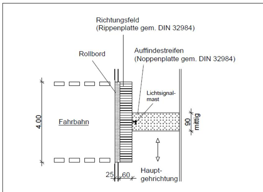
Bild 2: Rechteckige Querung mit Lichtsignalanlage
