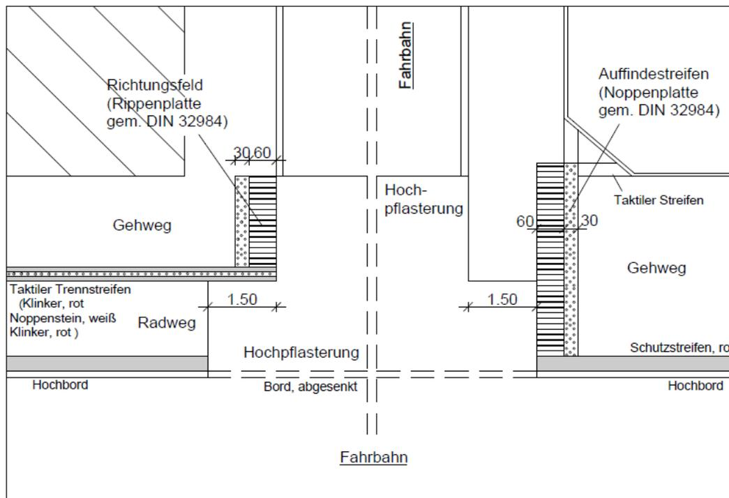
Bild 8: Querung mit Hochpflasterung
